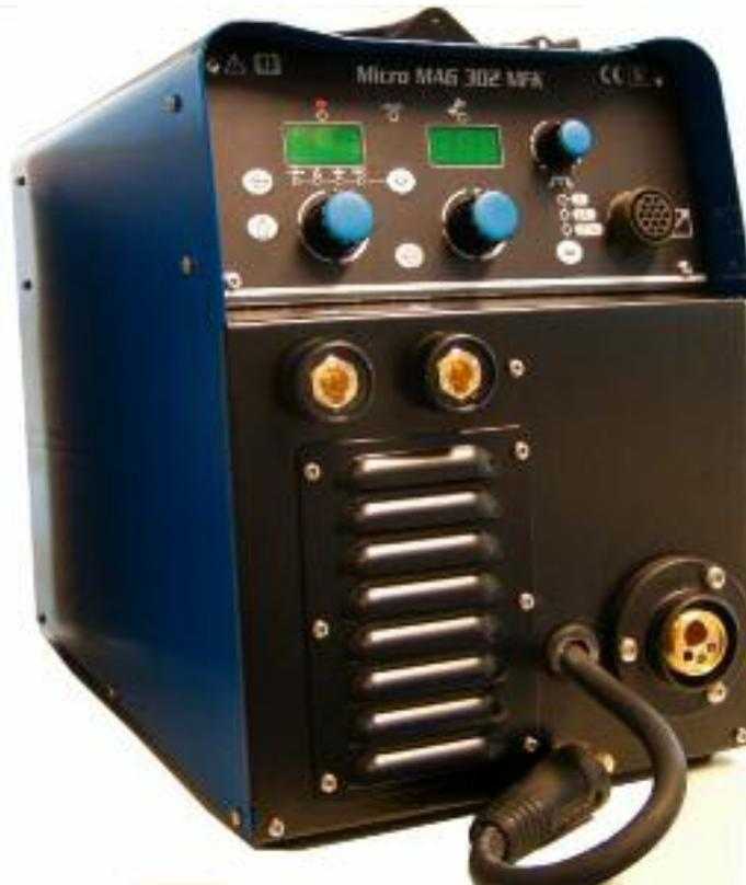
Inverter Elektrode/WIG Lift-Arc/MIG-MAG
